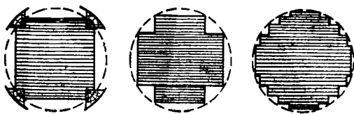
Рис. 9-4. Сечение сердечников трансформаторов.
